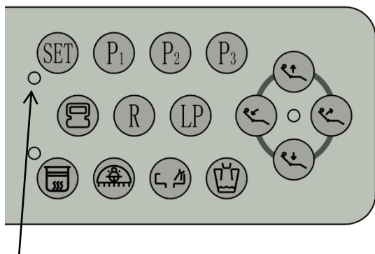
Индикатор, указывающий на активацию настроек программирования на модуле врача с нижней подачей
