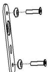
Благодаря прилагаемому металлическому кронштейну блок управления DUOPAD можно легко прикрепить к раме существующей стоматологической установки: сделайте два отверстия в каркасе установки, чтобы зафиксировать кронштейн с помощью двух винтов. Туго затяните два винта. Наконец, закрепите блок управления DUOPAD на двух выступах, вставив их в два отверстия и надавив на сам блок управления.
